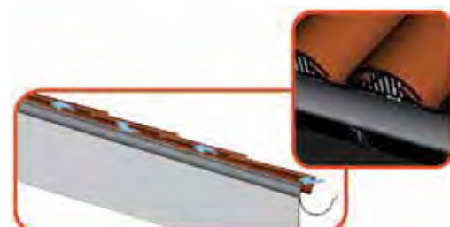
Entrada d'aire a través de la pinta del ràfec
